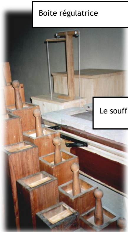
Le soufflet : un réservoir à plis derrière l'orgue
